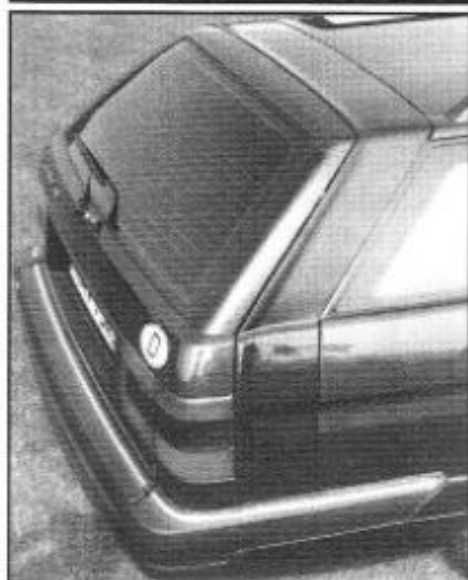
Tylna część pogrzebowego Citroëna wydłużona o 20 cm, przy zachowaniu oryginalnej klapy tylnej.
