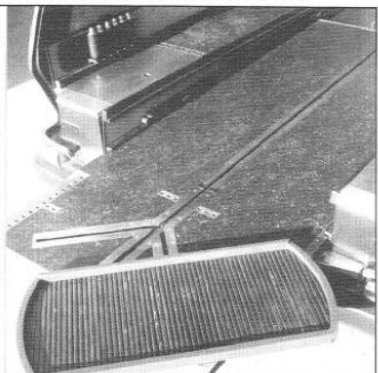
Wysuwana płyta podłogowa DUO ROTA z zasilaczem talerzowym (karawan mercedes 124 produkcji Rappolda)
